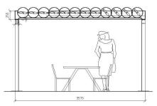
Das Pergolasystem mit den wasserführenden Speziallamellen kann komplett geöffnet werden.
