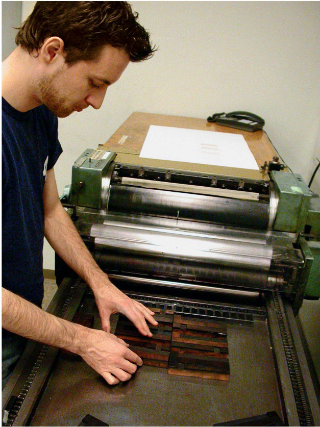
01 Bleisatz ist eine favorisierte Technik von Remo Caminada (Foto: Remo Caminada)
