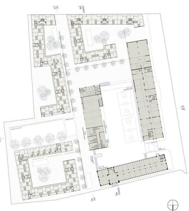
03 «La Ruche»: Der Entwurf von Bung architectes sieht vier Gebäude an einer internen Verbindung vor, die zugleich die vorhandenen Strassen miteinander verbindet. Dieser Weg wird durch zwei Plätze strukturiert, davon einer befestigt für diverse Aktivitäten des Quartiers und der andere begrünt als Plantage oder Gemeinschaftsgärten. Die Jury bewertete diesen eleganten und effizienten Entwurf von der Qualität her als gut, da er überzeugende Lösungen für die Umweltaspekte des Ökoquartiers bietet. Sie stellte sich allerdings die Frage, ob es mit dem Entwurf möglich ist, die Vorgaben für das Miteinander und die sozialen Bindungen im Quartier voll zu erfüllen
