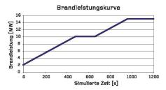
2 Die Brandkurve ist eine Angabe der Brandleistung (emittierte Wärme in MW) in Bezug auf die Branddauer. Diese wird meist anhand der brennenden Flüssigkeiten (Öl, Benzin etc.) sowie deren Mengen und Abbrandreihenfolgen bestimmt. In den vorliegenden Simulationen steigt die Brandleistung von 2 MW kurz nach Brandausbruch (Zeit = 0s) innerhalb von 8 min auf 10 MW an, bleibt für 3 min konstant und steigt anschliessend auf den Maximalwert von 15 MW.
