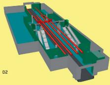
01 Volumenmodell der Station Brugherio 02 Perrongeschoss mit den vier Lüftungsrohren (Bilder: Pöyry Infra AG)
