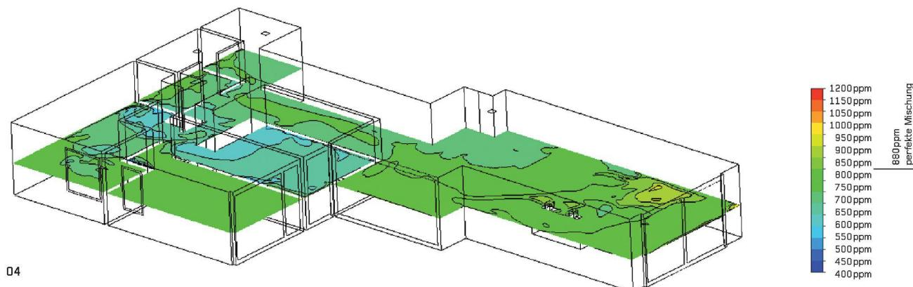
05 Volumenmodell einer grossen Halle mit Glasdach. Beim Fall 1 liegt die Abluftabsaugung unten, beim Fall 2 knapp unter dem Dach und beim Fall 3 in der Dachfläche selbst
