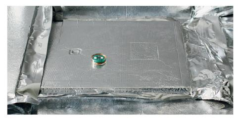
01 Ein Drucksensor im Innern des Vakuumisolationspaneels prüft ständig, ob das Vakuum noch vorhanden ist (Foto: Fraunhofer IMS)
