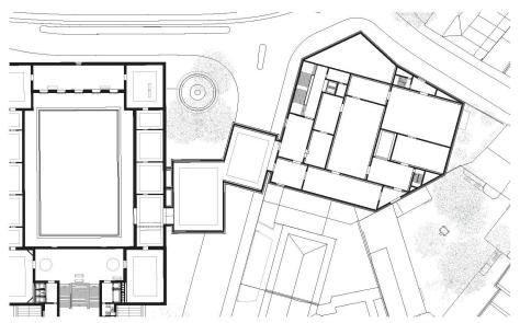
09 2. OG mit zwei Sälen über der Strasse als Verbindung zwischen Bestand und Neubau
