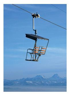
01 Einer der quer zur Seilachse verlaufenden Sessel der Seilbahn Weissenstein im Kanton Solothurn. Die Bahn wurde in den 1950er-Jahren von der Firma Von Roll erbaut (Foto: KEYSTONE/Martin Ruetschi)
