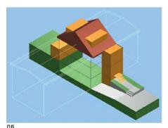
01-06 Modulartige, etappierbare Ausbauschritte: bestehendes Gebäude: 95-127 m², Ausbau Dachgeschoss; Wohnraumerweiterung: 32-36 m², Wohnraumerweiterung gartenseitig: 18-21 m², Erweiterung Windfang / sep. WC: 5-8 m², Erweiterung Bad: 0-8 m², Bruttogeschossfläche neu: 55-75 m², Bruttogeschossfläche total: 150-200 m²
