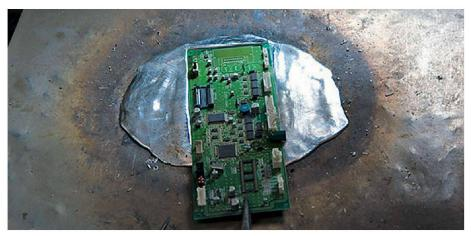
01 Computer-Mainboard wird in heissem Metall erhitzt, um die Lötstellen zu lösen (Foto: Time)
