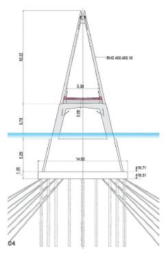
Die Konstruktion erhält durch dieses System die notwendige Steifigkeit. Die Spannseile werden beim Pylon umgelenkt, zu den Widerlagern geführt und dort verankert. Die Trag- und die Spannseile sind als vollverschlossene Spiralseile mit kombiniertem Korrosionsschutz ausgebildet, die Seilausfachung ist aus rostfreiem Stahl gefertigt.
