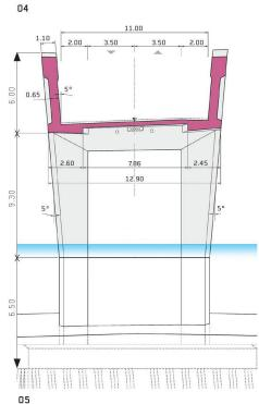
im Vorland als auch im Flussbereich mittels Ortbetonrammpfählen in den Untergrund übertragen. Zur Aufnahme der horizontalen Kräfte, insbesondere aus einem möglichen Schiffsanprall, ist bei den beiden Flusspfeilern je ein Kranz von schrägen Mikropfählen angeordnet, die über das unter Wasser liegende Pfahlbankett mit den vertikalen Pfählen und den Pfeilern verbunden sind.
