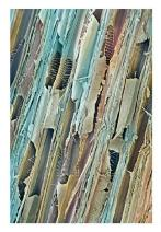
Kolorierte rasterelektronenmikroskopische Aufnahme eines Längsschnittes durch Holzzellen (Foto: KEYSTONE/SCIENCE PHOTO LIBRARY/ Steve Gscheissner)
