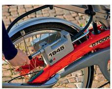
01 Ausleihvorgang bei einem Call-a-bike-Velo: Nachdem man per Mobiltelefon den Freischaltcode für das Fahrrad erhalten hat, tippt man die Zahlenkombination in den Bordcomputer ein, und das Schloss wird entriegelt. Die Rückgabe erfolgt in umgekehrter Reihenfolge: Nach dem Abschliessen erhält man einen Code, den man zusammen mit dem Standort an die Verleihzentrale weitergibt - der Vorgang ist abgeschlossen und wird nach der Dauer der Nutzung über die Kreditkarte abgerechnet
