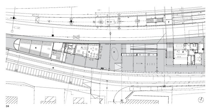
03 Veloparkhaus am Bahnhof Glattbrugg zwischen SBB-Gleisen und der neuen Glatttal-Bahn (Foto/Pläne: asa AG, Rapperswil) 04 Situation, Mst. 1:600; a) Veloparkhaus, b) Kiosk, c) Zentralbereich, d) Vogt-Bau, e) Tramstation Glatttalbahn, f) Perron 05 Längsschnitt durch das zweigeschossige
