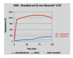
Die Brandeinwirkung auf eine Tunneldecke kann schon in den ersten fünf Minuten 1000°C erreichen. Darum werden Schutzsysteme extremen Bedingungen ausgesetzt, um deren Wirkung zu prüfen. «Sikacrete-213F» ist ein Spritzputz, hydraulisch gebunden, mit geblähtem Vermiculit als Füllstoff. Vermiculit ist ein Material mit ausserordentlicher Wärmedämmung.
