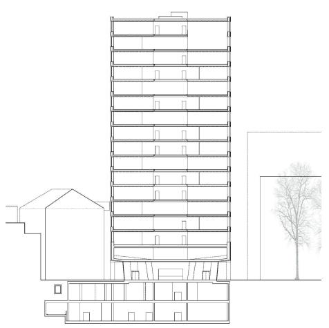
${\tt 03}$  «Tenedor»: Schnitt durch einen der gut 60 Meter hohen Türme mit Technikgeschoss im 1. OG
