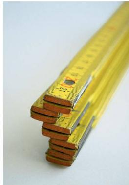
Meter, ein Messgerät zur Bestimmung von Längen. Erfunden wurde es in seiner jetzigen Form als Gelenkmaßstab 1865 vom Pfälzer Anton Ullrich. Sein Neffe Gustav Ullrich patentierte 1886 das Federgelenk, das beim Auf- und Zuklappen einrastet und so den Maßstab zusammenhält. Die Technik ist auch heute noch auf Baustellen im Einsatz (Foto: Anna-Lena Walther/red.)
