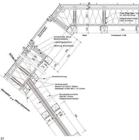
übertragen. Um das erwähnte duktile Verhalten zu erreichen, sind sie so bemessen, dass im Falle einer Überlast zuerst die Fasern der Hirnholzflächen in den Tragelementen gequetscht werden, bevor das Vorholz oder der Dübel selber spröd abscheren.
