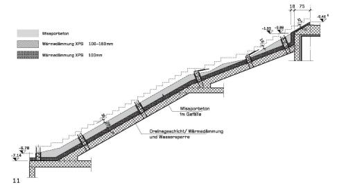
09 Nockendetail (Nadelöhr): Anschluss Decke an tragende Fassade
