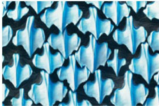
Haihaut-Schuppen unter dem Elektronenmikroskop. Die Rillenstruktur verringert den Reibungswiderstand, was z.B für Schwimmanzüge, Schiffe oder Flugzeuge genutzt werden kann
