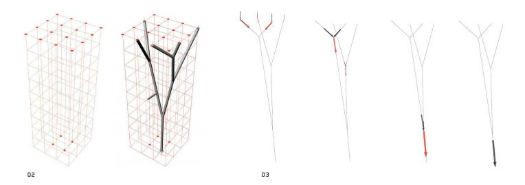
Die Modularität gab die für Planung und Ausführung notwendigen Bezugspunkte und erleichtert die Herstellung und das Fügen der Einzelteile sehr. In der Bauphase erlaubt die Festlegung einiger Achsen zudem die Montage aller Einzelteile sowie deren richtige Lage auf einfache Art zu überprüfen.
