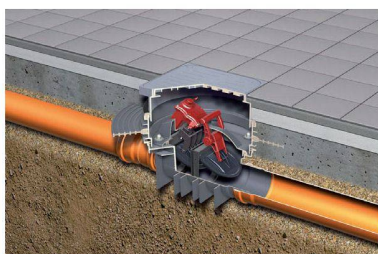
Der Fäkalien-Rückstauverschluss QUATRIX-K von ACO Haustechnik erleichtert durch einen reduzierten Gefällesprung von 12 mm den Einbau in vorhandene Grundleitungen mit geringem Gefälle. Durch beidseitige Spitzrohrenden ist der Einbau mithilfe von Schiebemuffen möglich.
