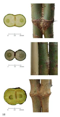
08 + 09 Werden Pflanzen im Raum angeordnet und miteinander speziell verbunden, können sie zu physiologischen Einheiten verwachsen. Anhand eines prototypischen Turms soll dieses Prinzip in grossem Massstab umgesetzt werden 10 Querschnitte durch Verwachsungen von Weide (hier zwei Stadien) und Platane (Fotos: Forschungsgruppe Baubotanik)
