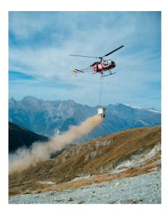
01 Die neue Richtlinie Hochlagenbegrünung soll die Qualität von Rekultivierungen im alpinen Raum erhöhen. Im Bild: Helikopter mit Saatgerät (Bild: M.Schwager)
