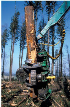
Der Greifarm eines Vollernters packt einen Baum und trennt die Äste vom Stamm. In Schweizer Wäldern sind solche Maschinen immer häufiger anzutreffen. Neue Regeln sind nötig, um auch künftig eine naturnahe Waldwirtschaft zu gewährleisten (Foto: AURA/Emanuel Ammon)
