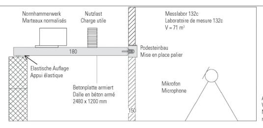
Abbildung 2: Prinzipskizze zum Versuchsaufbau an der EMPA. Das Messlabor 132c ist vollständig vom restlichen Gebäude abgetrennt
