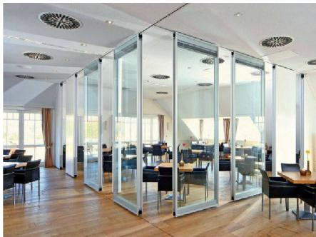
Mit dem Raumtrennsystem «MOVEO Glas» von Dorma lassen sich bewegliche, transparente Raumtrennsysteme mit bis zu  $R_w$  50dB Schallschutz realisieren. Das System kombiniert Transparenz mit hohem Schallschutz, Bedienkomfort und grosser Variabilität. Dafür sorgen doppelschalig verglaste Wandsysteme, deren Rahmen nur 30mm an den Längsseiten und 118mm im Kopf- und Sockelbereich messen. Ein Element ist 100mm dick, die lichte Höhe kann zwischen 2000 und 4000mm variieren. Die einzelnen
