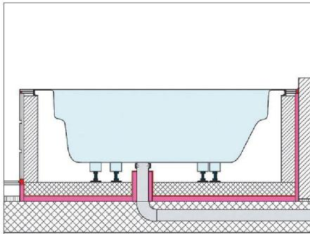
Whirlpools, Wellness- und Fitnessbäder werden immer beliebter. Durch den Pumpenbetrieb und an den Düsen der Whirlpools entstehen jedoch starke Vibratoren, die über die Poolkonstruktion direkt in das Gebäude eingeleitet werden. Diese Störenergien gelangen über Wände und Decken in andere Wohnungen und werden von den Nachbarn in der Regel als Belästigung empfunden. Bereits in der Planungsphase sind daher Massnahmen zur Reduzierung dieser Energien zu definieren.
