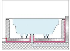
Whirlpools, Wellness- und Fitnessbäder werden immer beliebter. Durch den Pumpenbetrieb und an den Düsen der Whirlpools entstehen jedoch starke Vibrationen, die über die Poolkonstruktion direkt in das Gebäude eingeleitet werden. Diese Störenergien gelangen über Wände und Decken in andere Wohnungen und werden von den Nachbarn in der Regel als Belästigung empfunden. Bereits in der Planungsphase sind daher Massnahmen zur Reduzierung dieser Energien zu definieren.
