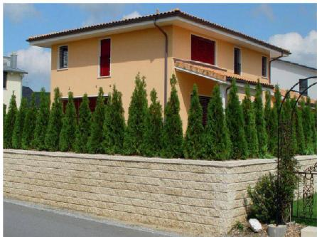
«Leromur» ist ein Trockenmauersystem in Natursteinoptik mit mediterranem Charakter. Es ist hoch belastbar und besitzt ein patentiertes Nockensystem. Die einzelnen Elemente werden vor Ort in die gewünschte Mauerstärke gespalten. Auf diese Weise können Stützmauern ohne Auflast bis 1.50m und freistehende Mauern bis 2.40m aufgebaut werden. In Kombination mit Geogittern sind Stützmauern bis zu 15m Höhe ausführbar. Spezielle Eckelemente erlauben die Ausbildung von Ecken von 45 oder 90°.
