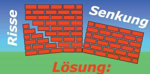
**Baugrund-Verfestigung** z.B. mittels
