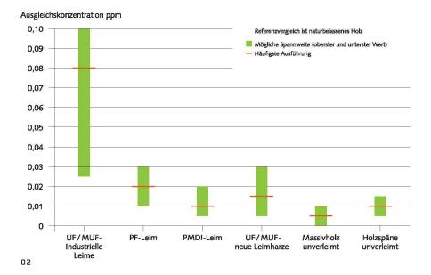
02 Formaldehydabgabe von Spanplatten in Abhängigkeit vom Bindemittel mit möglichen Spannbreiten (alle Bilder: Lignum)
