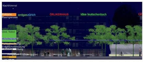
aläserne Lichtband (ein Leuchtenkanal aus Acrylalas mit eingehängter Neonröhre) (Bild: Heinz Rutz, Westiform)
