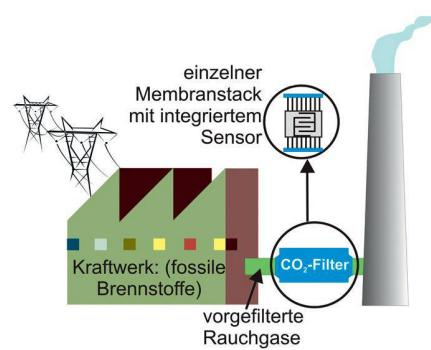
Mehr als ein Drittel der Kohlendioxidemissionen in Europa stammen aus Kraftwerken, die fossile Brennstoffe verfeuern. Eine Möglichkeit, diese Emissionen deutlich zu verringern, ist die Speicherung des Treibhausgases in unterirdischen Hohlräumen. Um Kohlendioxid unterirdisch zu speichern, muss es zuerst abgetrennt und aufgefangen werden. Die Trennung des CO<sub>2</sub>-Gases von den anderen Bestandteilen des Rauchgases ist derzeit noch schwierig und anspruchsvoll.
