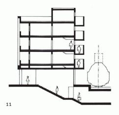
09 Stellwerk Nord im Vorbahnhof Zürich (1963) 10+11 Ansicht und Schnitt des Bahnhofs Killwangen-Spreitenbach AG (1970). Vogts wohl radikalste Fassade aus Laubengängen mit 2m hohen Brüstungen, die gegenüber den sechs Dienstwohnungen abgesenkt sind. Die ruhige Südseite besteht vollständig aus Loggien
