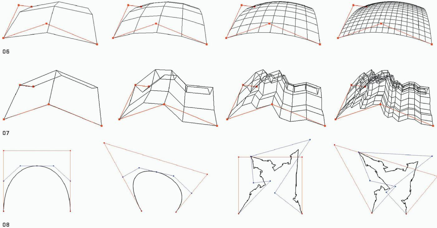
strukturellen Bedürfnissen am besten entspricht. Anschliessend wird die gewählte Form verfeinert. «Schalenkonstruktionen beispielsweise können im Hinblick auf den Kräftefluss optimiert werden: An den entscheidenden Stellen wird die Steifigkeit erhöht, indem man zusätzliche Faltungen einfügt», erläutert Weinand. «Neue Unterteilungen können aber auch genutzt werden, um den architektonischen Ausdruck, die Beleuchtung, die akustischen Eigenschaften oder die konstruktiven Elemente zu optimieren.»
