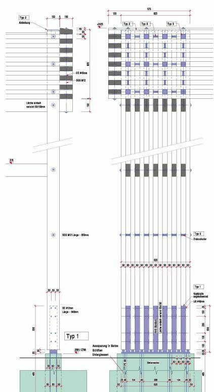
08 Die Tragkonstruktion aus Lärchenholz erfüllt die Aspekte des holzgerechten Enwurfs. Dank den luftumspülten Verbindungsstellen ist sie trotz starker Bewitterung dauerhaft (Plan: Raum B)
