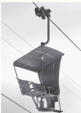
02 Sesselbahn Kandersteg–Oeschinensee BE mit seitlich angehängten Zweierseiln. Gebaut 1948 durch die von Roll (Bild: P. Hornung / SHS)
