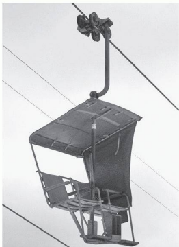
02 Sesselbahn Kandersteg–Oeschinensee BE mit seitlich angehängten Zweiersesseln. Gebaut 1948 durch die von Roll (Bild: P. Hornung / SHS)
