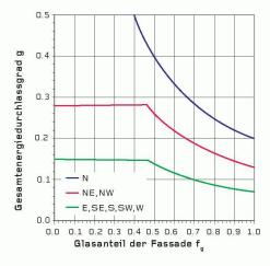
03 Anforderungen gemäss Norm SIA 382/1:2007 an den Gesamtenergiedurchlassgrad (g-Wert) für die Kombination von Glas und Sonnenschutz nach Fassadenorientierung und Glasanteil (f<sub>g</sub>) (Bild: Norm)
