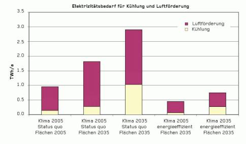
01 Veränderung des Elektrizitätsbedarfs in Abhängigkeit verschiedener Parameter: Variiert wurden die klimatischen Bedingungen, die Energieeffizienz der mechanischen Lüftung und Kühlung und der Anteil der belüfteten und gekühlten Gebäudeflächen (Bild: Autoren)
