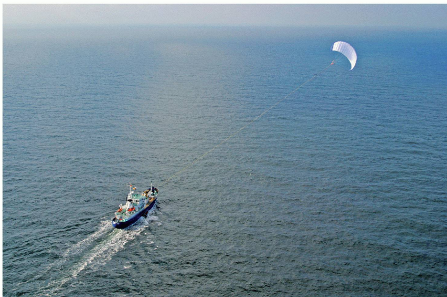
01 Testlauf mit dem Küstenschiff MS «Beaufort» im Jahr 2007: Der Zugdrachen steigt bis zu 300 m hoch und nutzt dort die beständigen höheren Windgeschwindigkeiten (Bild: Skysails, Hamburg)
