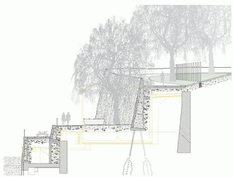
03 Natursteinmauern überwinden die Höhendifferenz von bis zu 9m zwischen Fluss und Novartis-Campus
