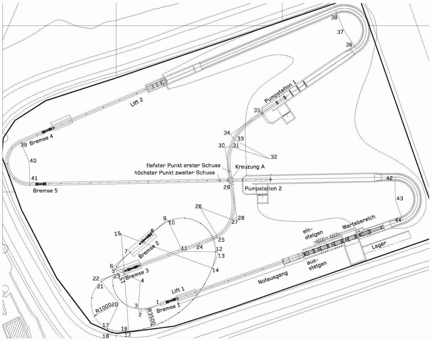
**04 + 05** Layoutvorschlag eines Water Coaster mit einer Streckenlänge von ca. 710m und einer Höhe von ca. 23m. Mit einer Geschwindigkeit von 68 km/h können jeweils 8 Personen in einem Boot die Anlage durchfahren. Ausgelegt ist die dargestellte Anlage auf dem Einsatz von 13 Booten, damit ergibt sich eine theoretische Kapazität von 1350 Pers/h. Der Wasserdurchfluss einer solchen Anlage beläuft sich ca. auf 2,7 m<sup>3</sup>/s bei einem Energieverbrauch von rund 580 kW/h
