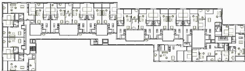
Ein verglaster Laubengang, an den ins Volumen eingeschnittene Höfe anschliessen, ist das Entwurfsthema für dieses Wohnen im Alter in Köniz (1.Rang, von Ballmoos Krucker)
