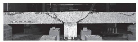
**02 Im Modell simuliertes Bruchbild** (Bild: ETH Lausanne)
