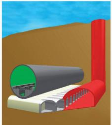
07 Tunnelabschnitt des Projekts «MAULWURF» mit der aus 11 Querstollen bestehenden Knautschzone unter dem Tunnel; Längsstollen und Zugangsschacht (3. Preis: IG AEGP, Regensdorf)
