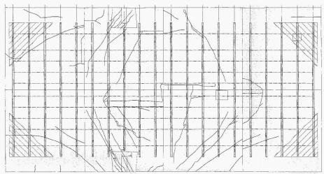
03 Tunnelgewölbe in der Schadenzone: Rissbild der Innenschale im Scheitelbereich und Lage der Stahlsegmentbögen
