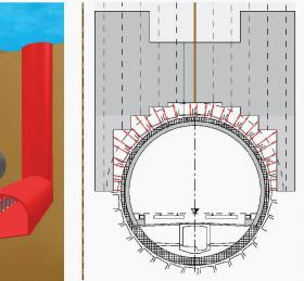
08 Tunnelquerschnitt des Projekts «Condor» mit Verdichtungsinjektionen über der Kalotte (IG GeoAdler, Bern)
