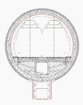
06 Tunnelquerschnitt des Projekts «EAGLE ONE» mit Entlastungsstollen und tangentialen Entlastungsbohrungen unter der Tunnelsohle
