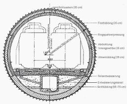
02 Tunnelquerschnitt (Profiltyp I für «quellfähiges Gestein»)
