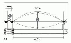
von 1.2 m sind 4 m breit, an den Gebäudeenden 108 m und dazwischen 54 m lang. Sie werden mit trockener Luft je nach Witterungsbedingungen unter einem Druck von 250–500 Pa pneumatisch gespannt. Um die von innen in die Kissen diffundierende Feuchtigkeit abzuführen, werden die Kissen mit einer geringen Luftrate permanent durchströmt. Die gesamte Dachkonstruktion weist entsprechend den Herstellerangaben mit den dreilagigen Kissen einen Wärmedurchgangskoeffizienten von 2.0 W/m²K auf.
