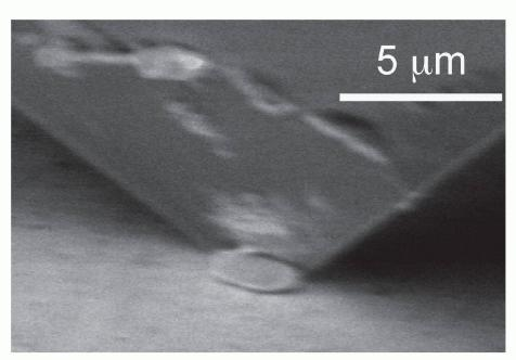
01 Der Cube-Corner, eine Diamantpyramide, hinterlässt Spuren auf einer Glasoberfläche (Bild: Empa)
