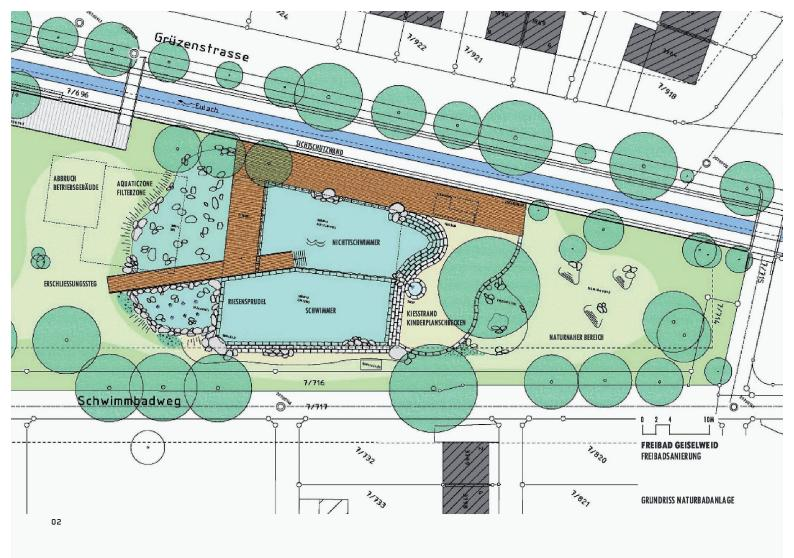
Das Badewasser wird auf diese Weise kontinuierlich 1 bis 1.5 Mal pro Tag umgewälzt. Die biologische Reinigungsleistung ist auf maximal 300 Badende pro Tag ausgelegt. Pumpen und Sauerstoffzufuhr in der Filterzone werden aber auch ausserhalb der Badesaison betrieben, damit der Bakterienrasen erhalten bleibt. Der ganzjährig wassergefüllte Teich erhöht auch die Attraktivität des Geländes im Winter, wenn das Freibad zum öffentlichen Park wird.
