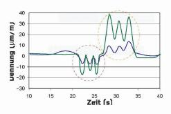
Messstreifen 1Messstreifen 2Bus (Spur 2)Tram (Spur 1)
