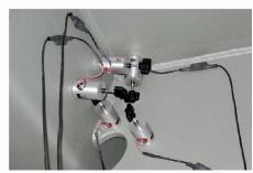
getestet. Anhand der Messungen mit den Reibungsmessstreifen konnte, wie schon bei der Kirchenfeldbrücke, ein Modellfaktor zur Reduktion der berechneten Beanspruchung und die effektive Exzentrizität der gemessenen Elemente definiert werden.
