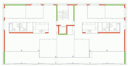
Die Erdbebenkräfte der Zone 3b erfordern über die ganze Gebäudehöhe laufende Stahlbetonwände (grün)
