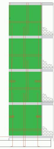
Bewehrungsführung in duktiler Stahlbetonwand
