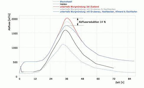
03 Auswirkungen der Rückhaltebecken Grubenau, Hasli (bestehend), Allmend sowie des Entlastungskorridors Eschikofen auf die Abflussdämpfung des Spitzenabflusses bei einem Extremereignis (Bilder: Autoren) Bei einem Extremereignis geht es darum, eine unkontrollierte Überflutung der Dämme und die daraus folgenden Dammbrüche zu verhindern. Als Massnahmen kommen Rückhaltebecken oder Entlastungskorridore in Frage, welche die Abflussspitze flussabwärts dämpfen.
