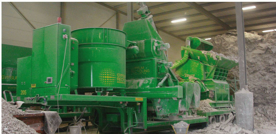
In der mobilen Recycling-Anlage entsteht aus gipshaltigen Bauabfällen neues Gipspulver, aus dem erneut Gipsplatten hergestellt werden können (Bild: GR Gips-Recycling AG)
