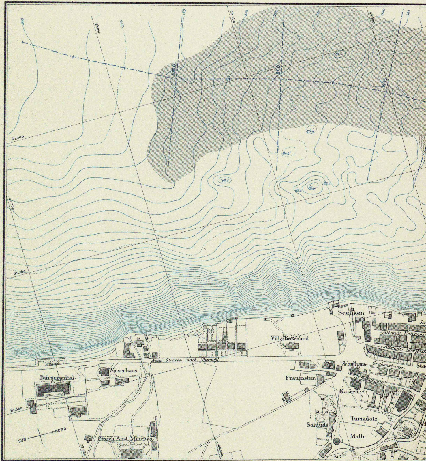
Seegrundvermessung des eidgen. topogr. Bureau (aufgen. von Jng. Hörnlmann & Suter.)
